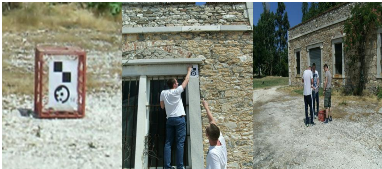
Fig. 14. Montarea punctelor artificiale pe fațada clădirii
