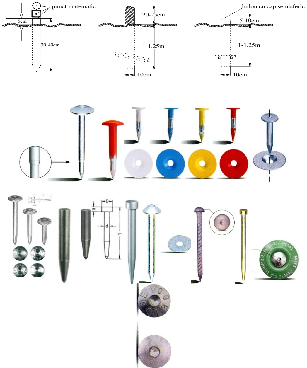
Fig. 3.1. Țăruș, stâlpi din lemn și picheți metalici
