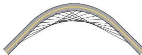
Figura TP-21. Determinarea grafică a zonei de degajare laterală în curbă
