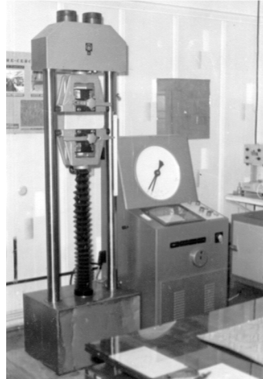
Fig. 6. Presă pentru determinarea rezistenței la compresiune.
