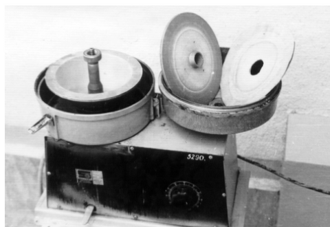
Fig. 3. Centrifuga de extracție pentru determinarea conținutului de liant.
