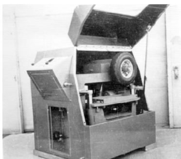
Fig. 13. Simulatorul de fâgașe.
