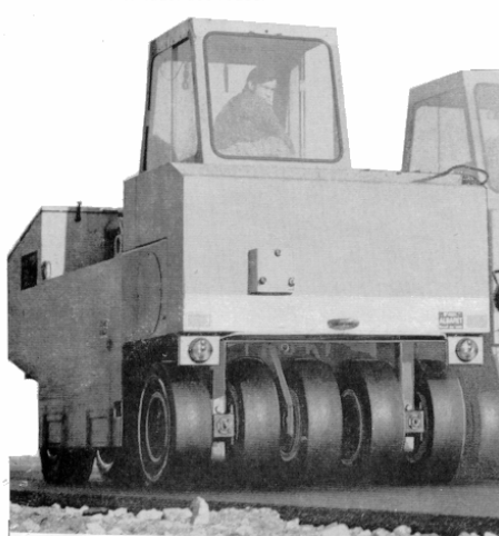
Fig. 27. Compactor cu pneuri.
