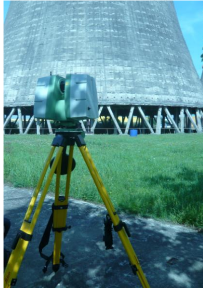
Figura 1.6 Laser scanner terestru
