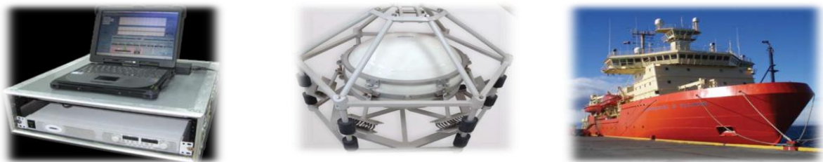
Fig. 2.6: Sistemul de control (stânga), sfera de aluminiu cu gravimetrul (mijloc) și vasul-mamă (dreapta)
