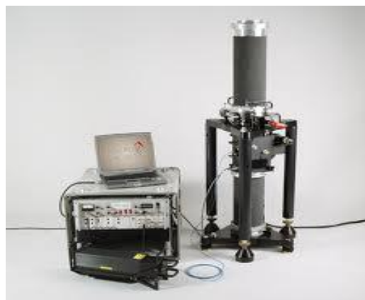
Fig. 3.4: Punctul gravimetric absolut Timișoara (stânga) și gravimetrul FG-5 utilizat (dreapta)
