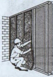
10. Aplicarea stratului de izolare (vată minerală).
