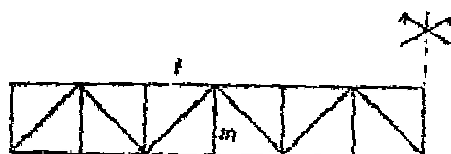
triunghiular cu montanți și tiranți suplimentari
