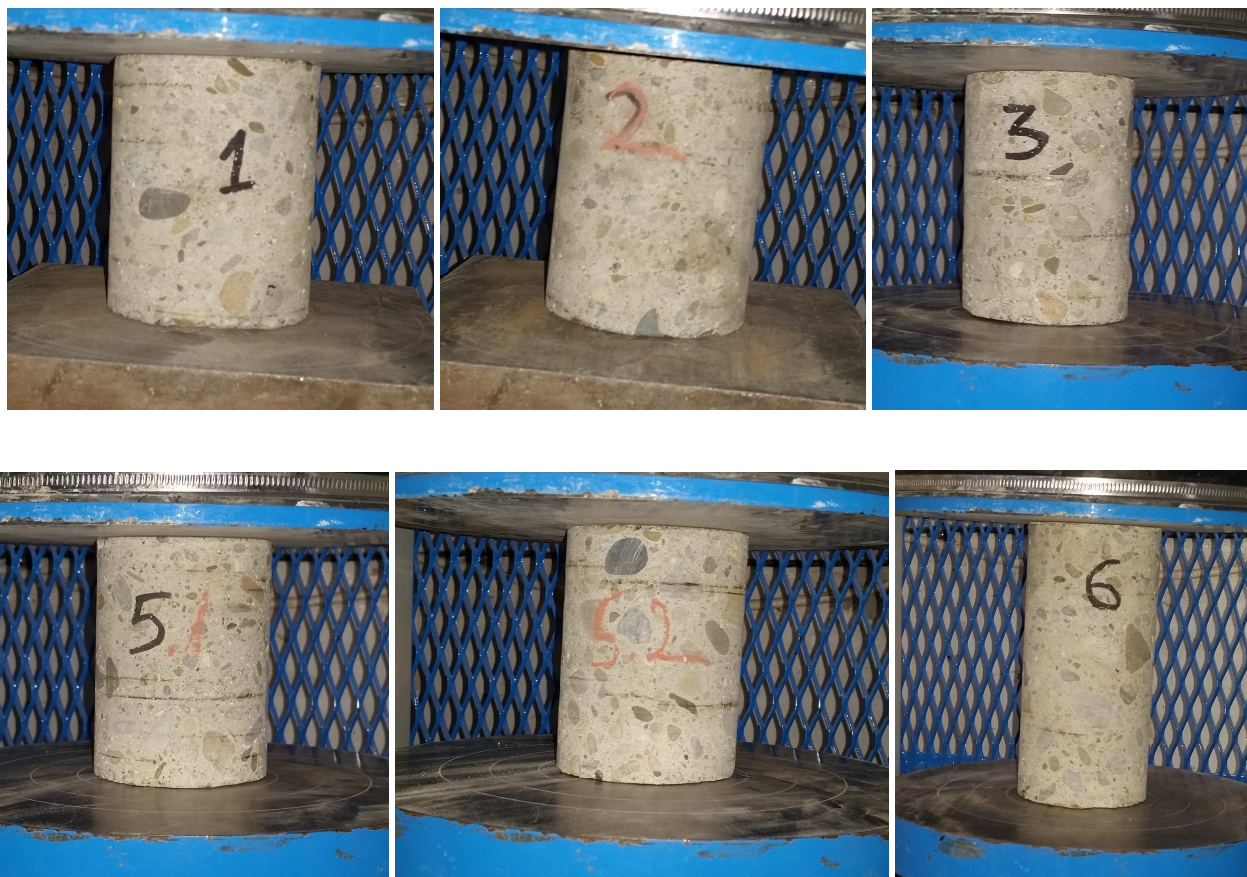
Figura 3 Testarea carotelor la compresiune
