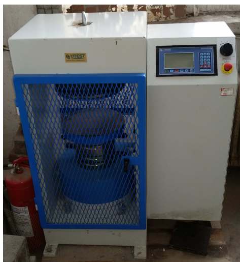
Figura 3 Presa hidraulică automată
