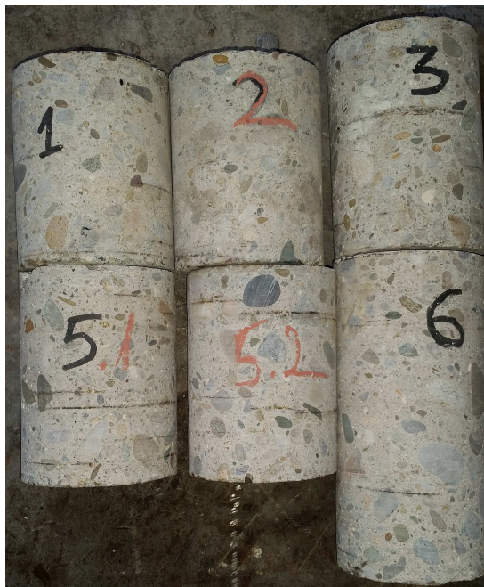
Figura 1 Pregătirea carotelor pentru testare
