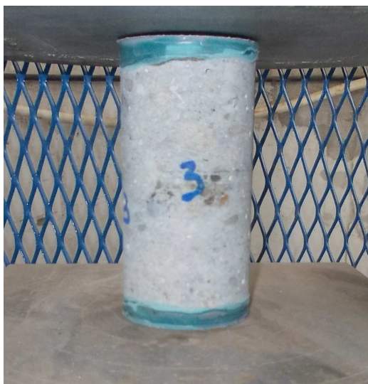
Figura 4 Testarea carotelor la compresiune
