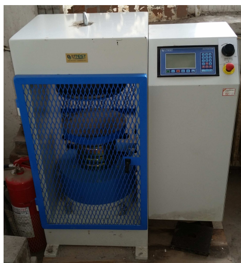
Figura 2 Presa hidraulică automată
