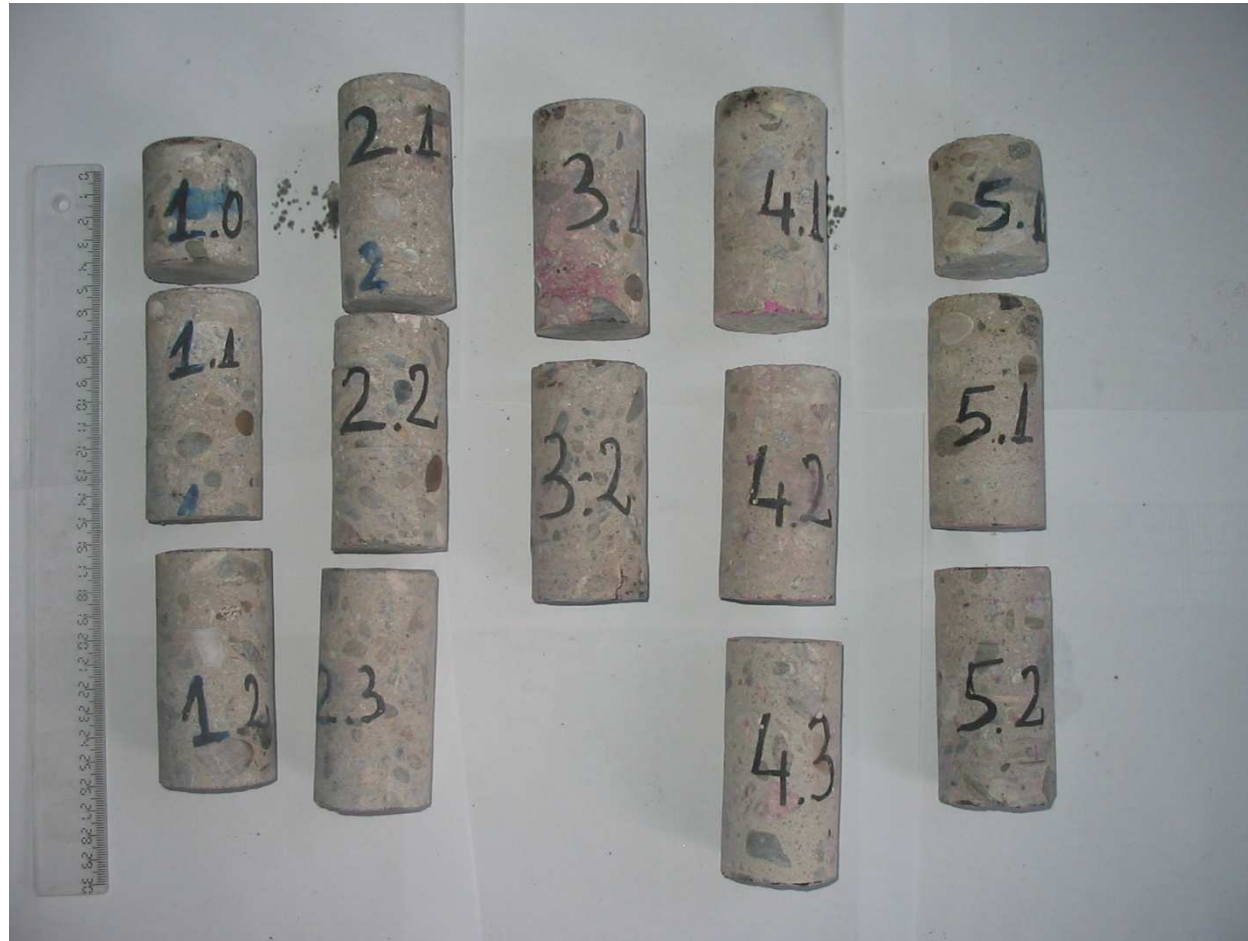
Epruvetele rezultate în urma debitării carotelor.
