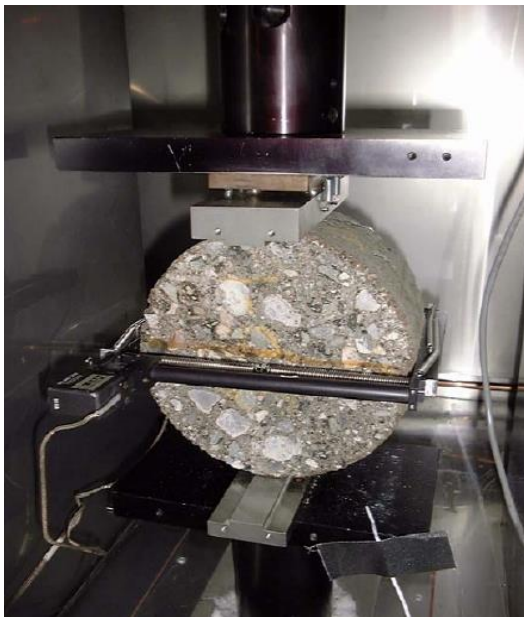
Fig. 1.15. Încercarea cu măsurarea diametrului orizontal.
