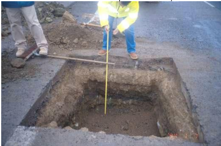
Fig. 1.1. Sondaj în structura rutieră.
