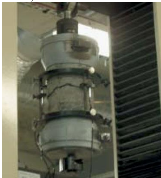
Fig. 1.6. Determinarea rezistenței la întindere și a modulului de elasticitate.
