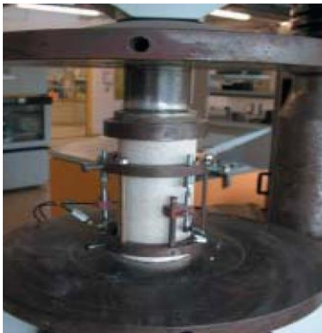
Fig. 1.2. Determinarea rezistenței la compresiune și a modului de elasticitate.
