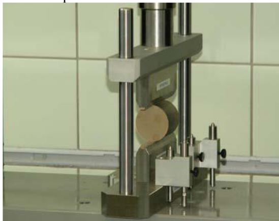
Fig. 1.8. Determinarea rezistenței la întindere prin încercarea braziliană.
