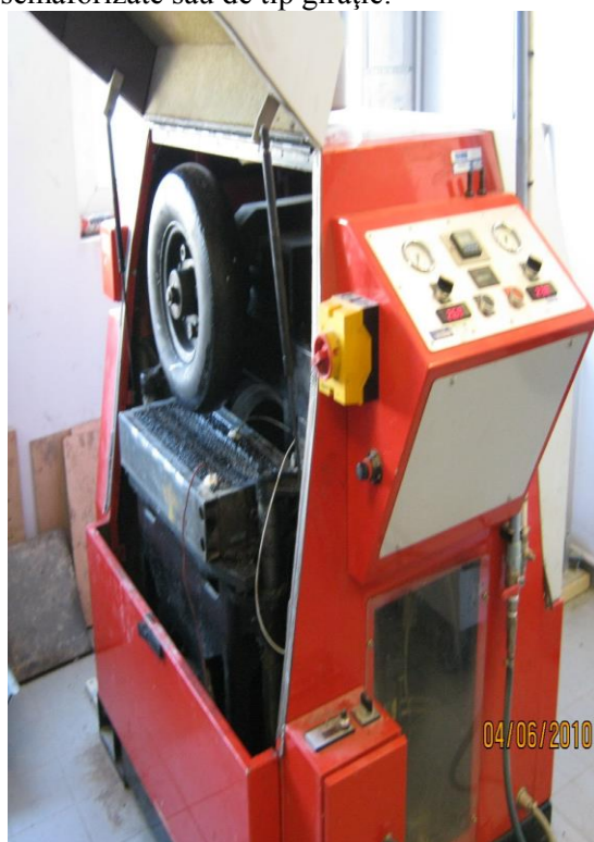
Fig. 1.26. Aparat pentru determinarea rezistenței la ornieraj.
