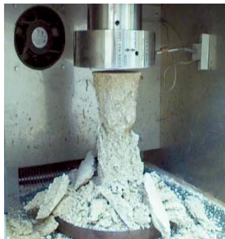
Fig. 1.3. Ruperea epruvetei prin solicitarea la compresiune.
