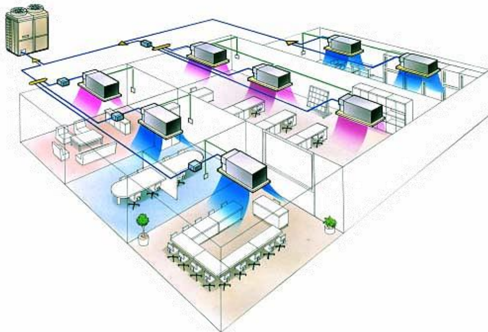
Fig.6.5 Sistemul VRV pe parte de răcire și încălzire
