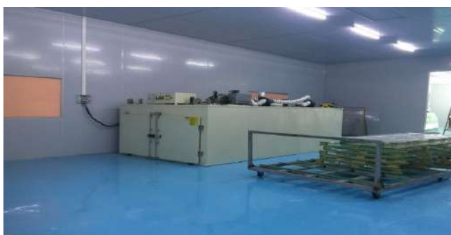
Figura 5. Cuptor special pentru laminare [4]
