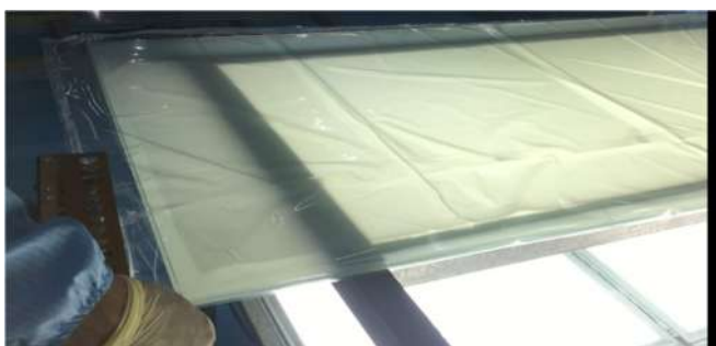
Figura 4. Înfășurați sticla laminată acoperită cu pungă PET [4]
