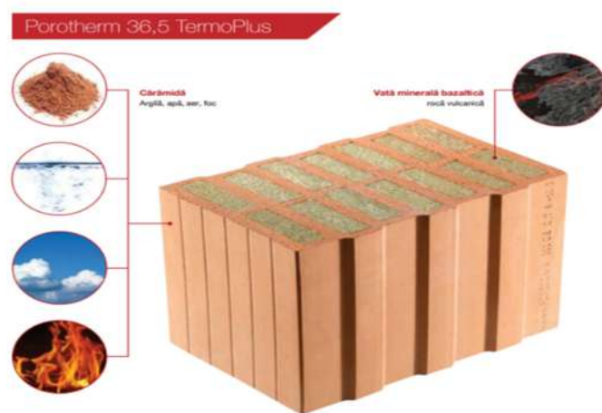
Fig.1. Cărămidă cu goluri umplute cu vată bazaltică. [5]
