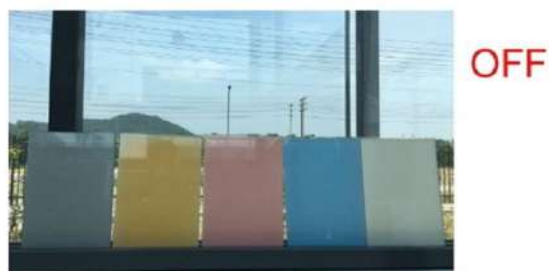
Figura 9. Sticlă cu cristale lichide dispersată în polimeri atunci când nu se aplică electricitate pe sticlă. [7]
