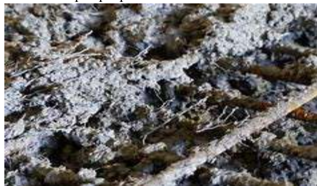
Figura 4. Beton armat cu fibre de polipropilenă, proaspăt turnat.[3]
