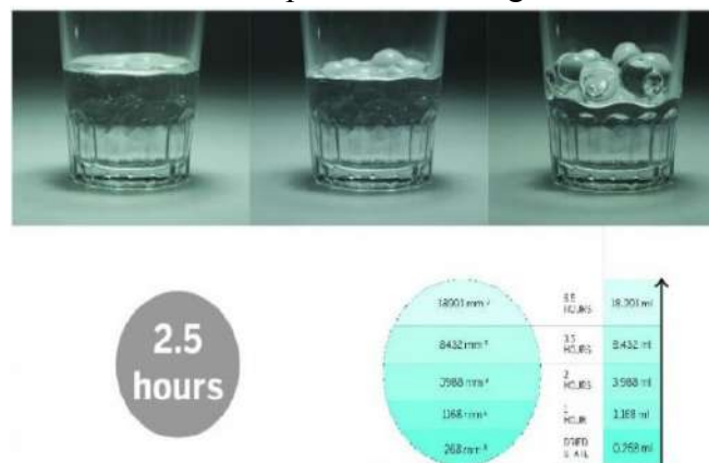
Figura 1. Comportarea hidrogelului în apă [6]
