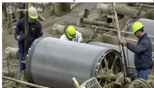
Figura 1. Proces de fabricare a plăcilor din fibrociment [6]
