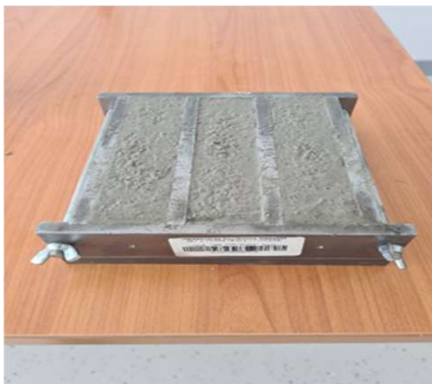
Figura 4. Proba care este pusă la uscat timp de 28 de zile, având dimensiunile de: L = 150 mm și l = 45 mm
