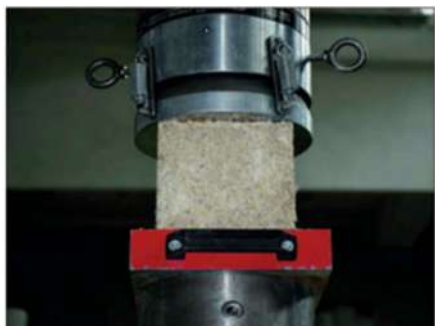
Figura 4. Testul la compresie cu presa hidrolică MTS 810 [13]
