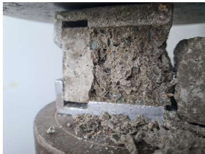
Figura 5. Proba supusă la compresiune
