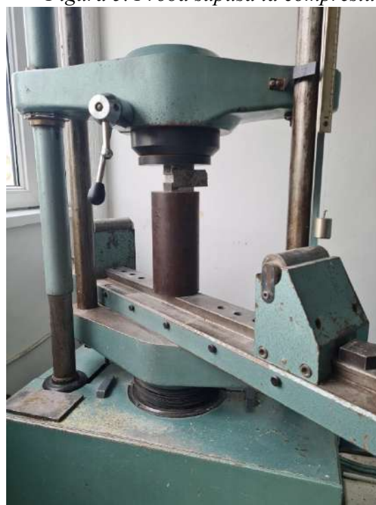
Figura 6. Proba supusă la compresiune 1
