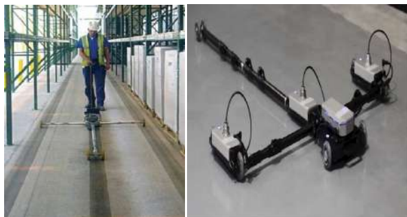
Figura 13. Aparat de măsurare - profilmetru [17]
