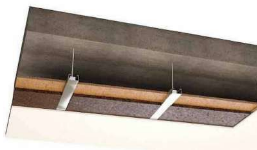
Figura 7. Tavan izolat cu material de plută [10]
