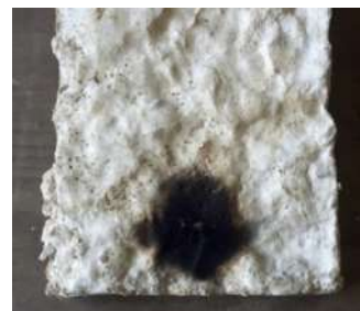
Figura 6. Degradarea panoului în urma testului la foc [5]
