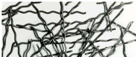
Figura 1. Fibre metalice pentru armarea dispersă [2]
