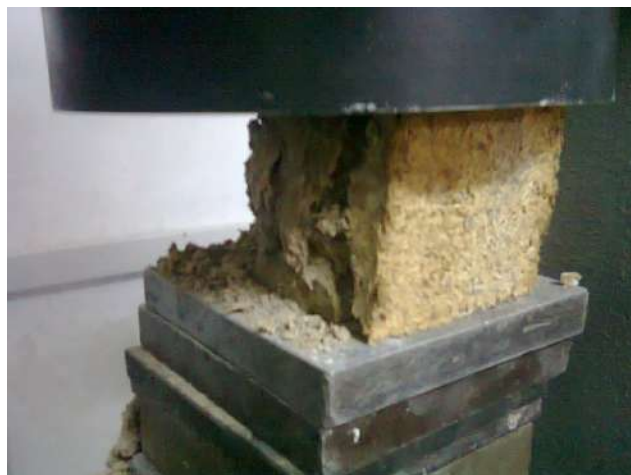
Figura 2. Testarea rezistenței la compresiune a epruvetei de mortar cu rumeguș
