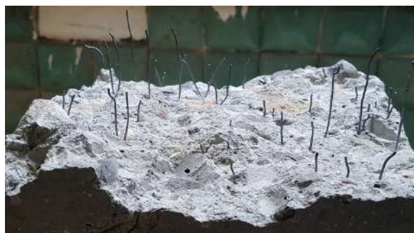
Figura 2. Fibrele metalice în compoziția betonului [3]
