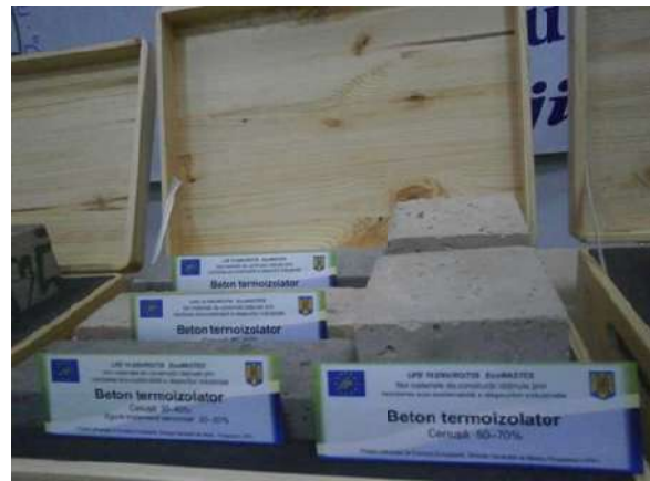
Figura 3. Mostră de beton termoizolator cu cenușă în compoziția sa în proporție de 50-70% (mostrele din partea dreaptă) [3]
