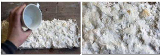
Figura 7. Realizarea testului la apă / umiditate [5]
