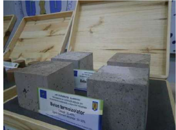
Figura 2. Mostră de beton termoizolator cu cenușă în compoziția sa în proporție de 30-40% [3]
