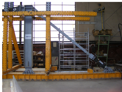
Figura 11. Încercări experimentale pe ansamblu contravântuire-amortizor: (a) stand experimental, (b) comportarea ciclică [13][14]
