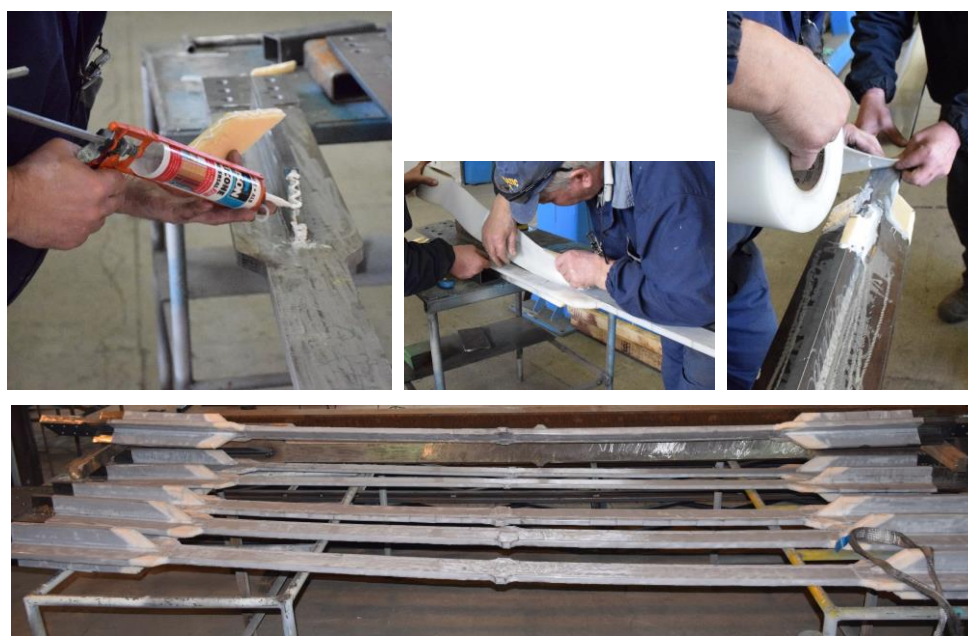
Figura 3-18. Aplicarea materialului compresibil și a stratului neaderent.
