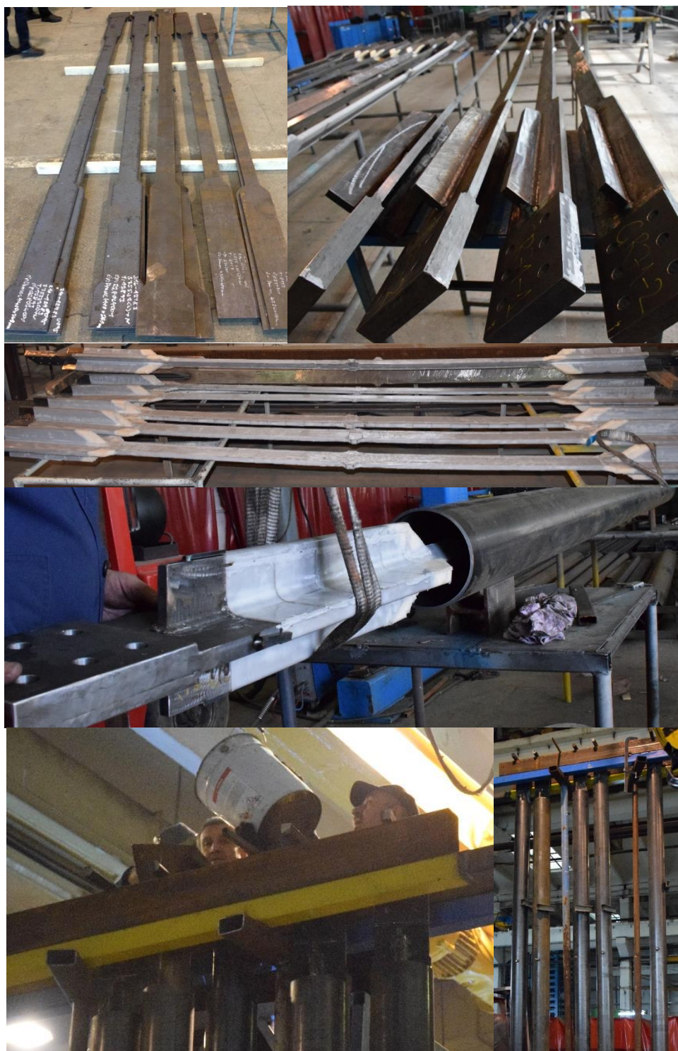
Figura 13. Etapele tehnologice de realizare a BRB-ului: debitarea pieselor metalice; asamblarea miezului; aplicarea materialului compresibil și a stratului neaderent; asamblarea BRB-ului și centrarea miezului; turnarea mortarului/betonului.
