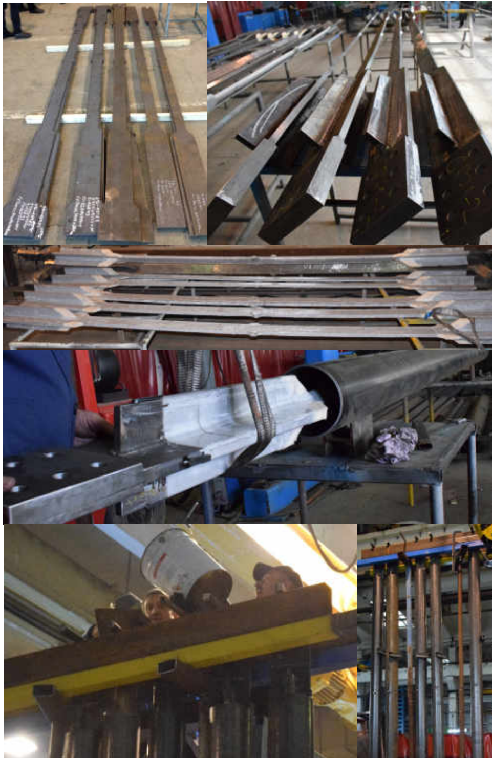
Figura 2. Etapele tehnologice de realizare a BRB-ului
