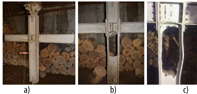
Fig. 6 - Fotografii cu stalpii incercati la explozie: a) înainte de încercare; b) specimenul 1 după ultima încercare; c) specimenul 2 după ultima încercare (CODEC)
