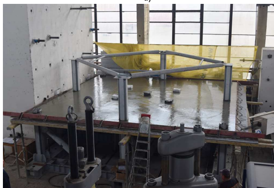
Fig. 5 Specimen experimental Ans-SD: a) montarea tablei cutate amprentate; b) montarea armaturilor și sudarea conectorilor; c) turnarea betonului în placă; d) specimenul înainte de încercare
