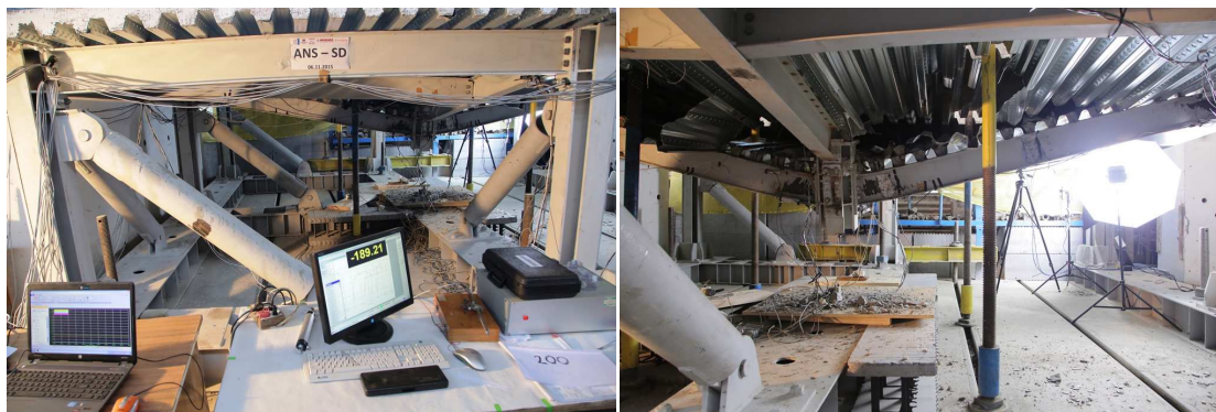
Fig. 9 Vedere de ansamblu cu specimenul Ans-SD in timpul incercarii (s) si dupa incercare (d)
