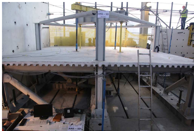
Fig. 4 Stand și specimene experimentale pentru încercarea pe structură la cedarea unui stâlp: a) Ans-M (testat 2014); Ans-C (testat 2014); c) Ans-SD (testat 2015);
