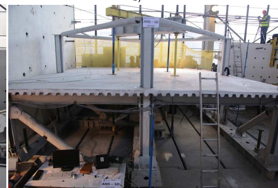
Fig. 5 Specimen experimental Ans-SD: a) montarea tablei cutate amprentate; b) montarea armaturilor și sudarea conectorilor; c) turnarea betonului în placă; d) specimenul înainte de încercare
