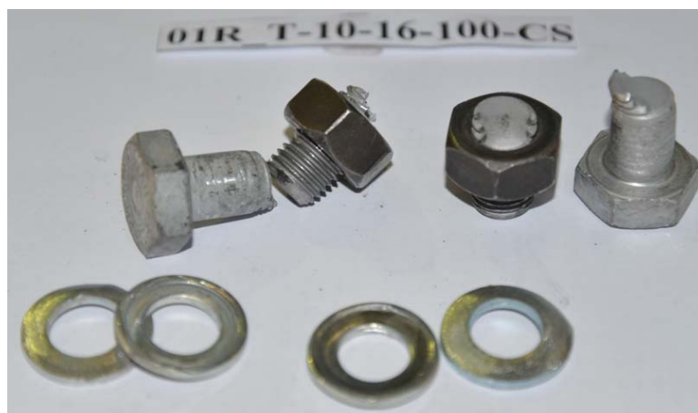
Fig. 22 Detaliu cu suruburile cedate
