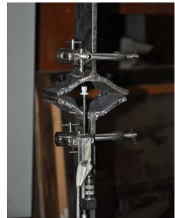
Fig. 17 Încercări la temperatura camerei: a) stand cu specimen; b) detaliu cu specimenul înainte de cedare
