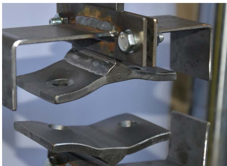
Fig. 23 Detaliu cu elementul T-stub si sudura de colt inima-talpa sudata după cedarea specimenului
