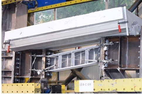
Figura 21. Deformația și cedarea și starea linkului la sfârșitul încercării LE4-C-BR
