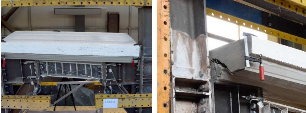
Figura 19 .Deformația și starea linkului și a plăcii din beton la sfârșitul încercării LE3-C-B
