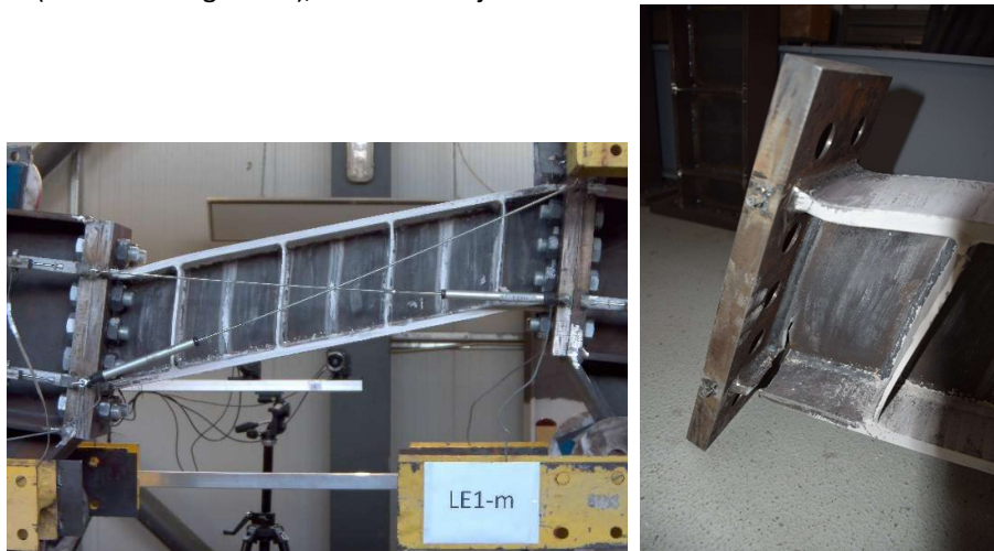
Figura 15. Deformația și cedarea și starea linkului la sfârșitul încercării LE1-M
