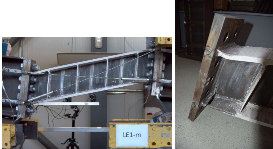
Fig. 7 – Deformația și cedarea și starea linkului la sfârșitul încercării LE1-M
