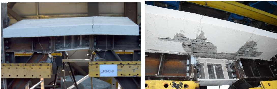
Fig. 15 – Deformația și starea linkului și a plăcii din beton la sfârșitul încercării LE3-C-B
