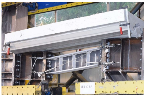
Fig. 13 – Deformația și cedarea și starea linkului la sfârșitul încercării LE4-C-BR
