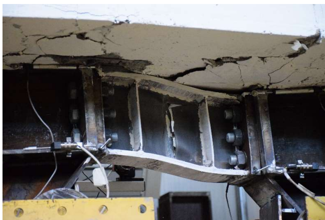
Fig. 18 – Deformația și cedarea și starea linkului la sfârșitul încercării LF4-C-BR
