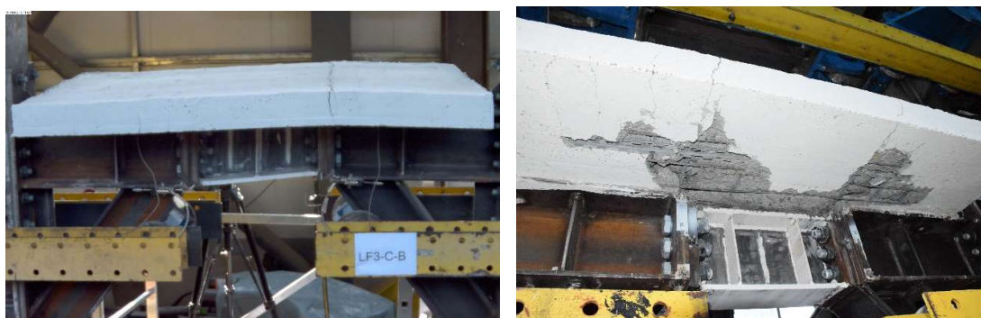
Fig. 23 – Deformația și starea linkului și a plăcii din beton la sfârșitul încercării LE3-C-B
