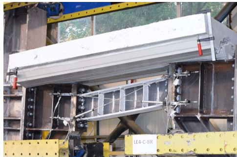
Fig. 19 – Deformația și cedarea și starea linkului la sfârșitul încercării LE4-C-BR
