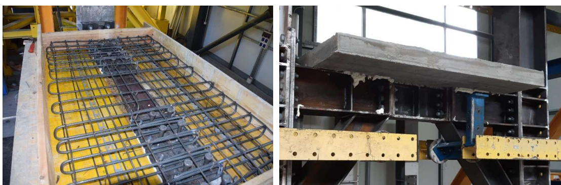
Fig. 22 – Placa din beton: armare și vedere 3D
