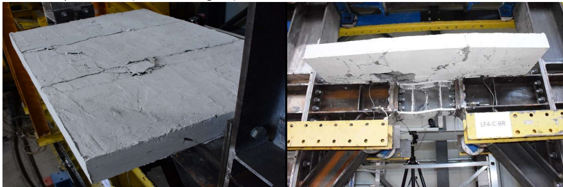
Fig. 29 – Deteriorarea plăcii din beton armat la sfârșitul ultimei încercări
