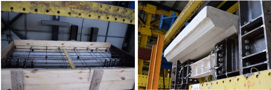
Fig. 15 – Placa din beton: armare și vedere 3D
