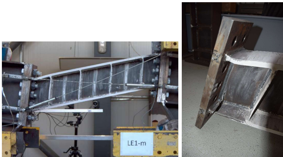
Fig. 8 – Deformația și cedarea și starea linkului la sfârșitul încercării LE1-M
