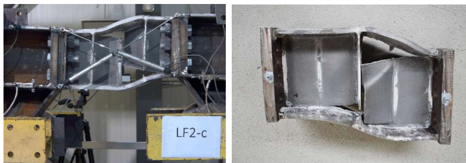
Fig. 5 – Modul de cedare și starea linkului la sfârșitul încercării LF2-C
