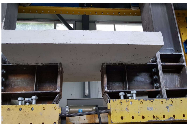
Fig. 25 – Placa din beton armat reparata
