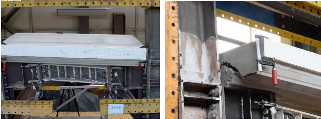
Fig. 16 – Deformația și starea linkului și a plăcii din beton la sfârșitul încercării LE3-C-B
