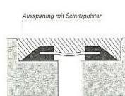
Fig. 4: Bei Bedarf kann über die Abdichtung auch ein Schutzpolster aus z.B. Hart- oder Weichschaumstoff angeordnet werden.
