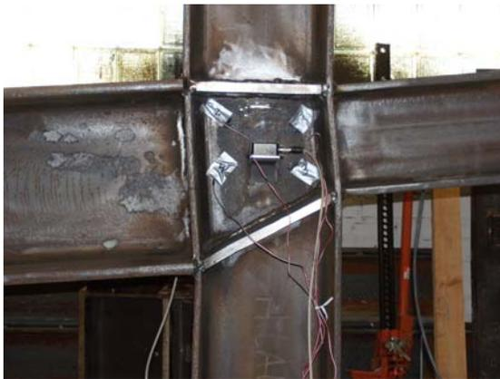
Figure 9a. Panel inelastic deformation
